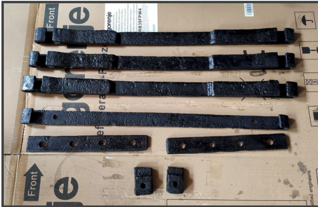
A Korant-tal kezelt felületek a kémiai reakció során szépen befeketedtek.
