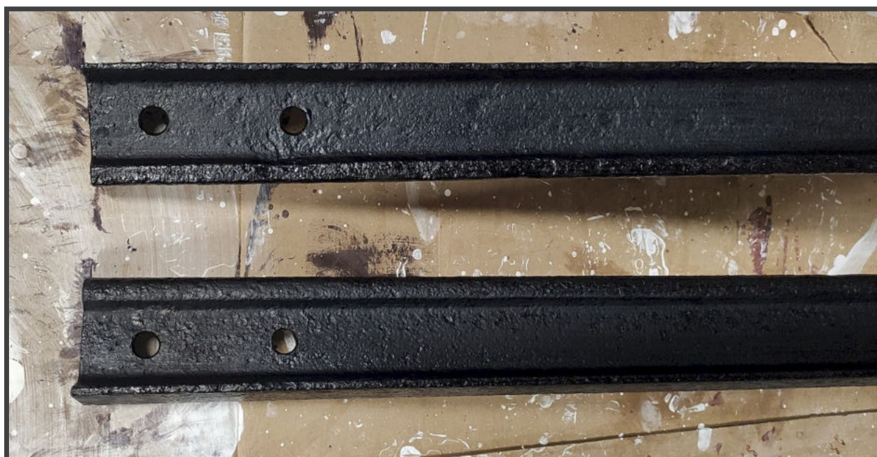
A Korant-os kezelés eredményeként befeketedett a felület, reméljük tartós lesz.
