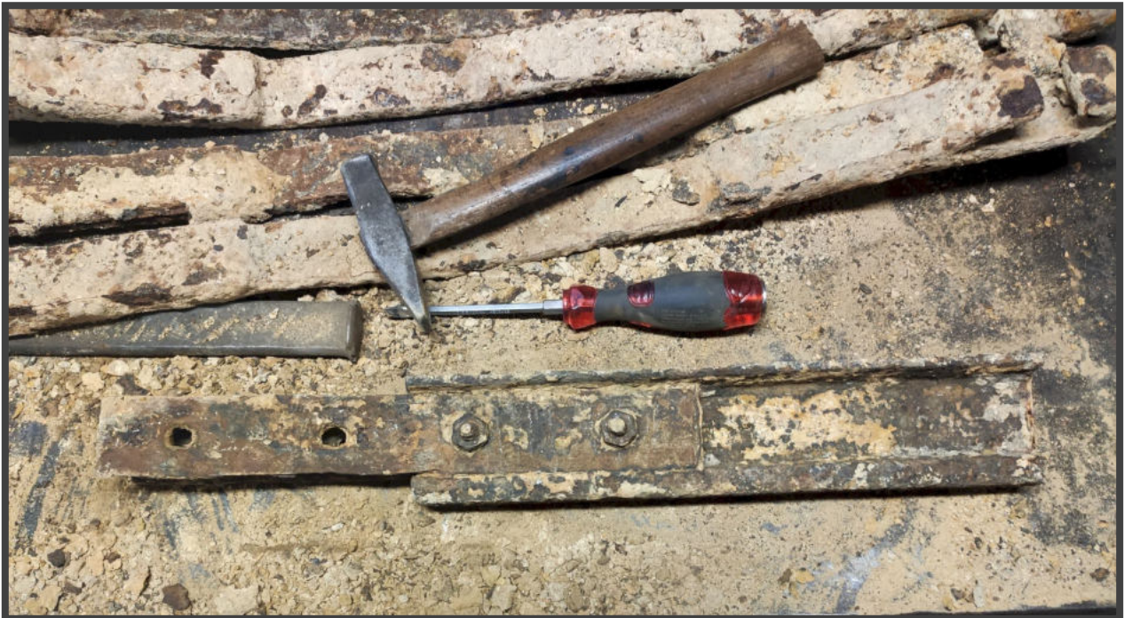
A mechanikai tisztítás első lépése, az alkatrészekre száradt agyagpáncél eltávolítása, véséssel, kalapálással történt.
