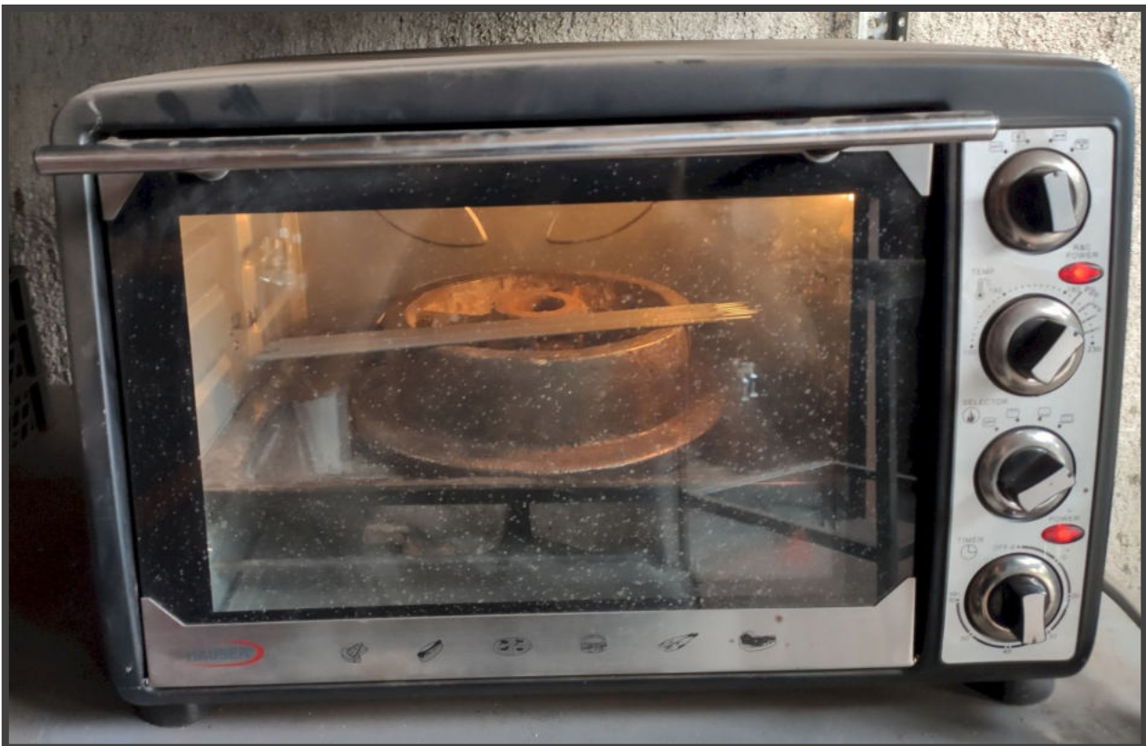
A munkadarab előmelegítése, a hegesztő elektródák szárítása. A tálcat alulról samott-églával alá kellett támasztani, mert a kerék tömege (10,25 kg) miatt leszakadt volna.
