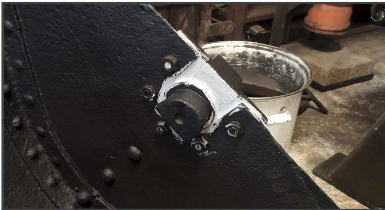
Az illesztési hézagok tömítése autóiipari (karosszéria) akril tömítővel.
