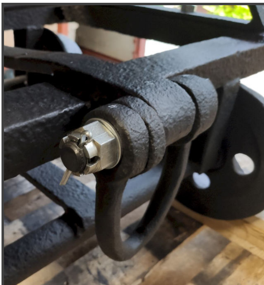
Az olyan apró részletekre is figyelni kellett, mint pl. a sasszegek furatainak elkészítése.
