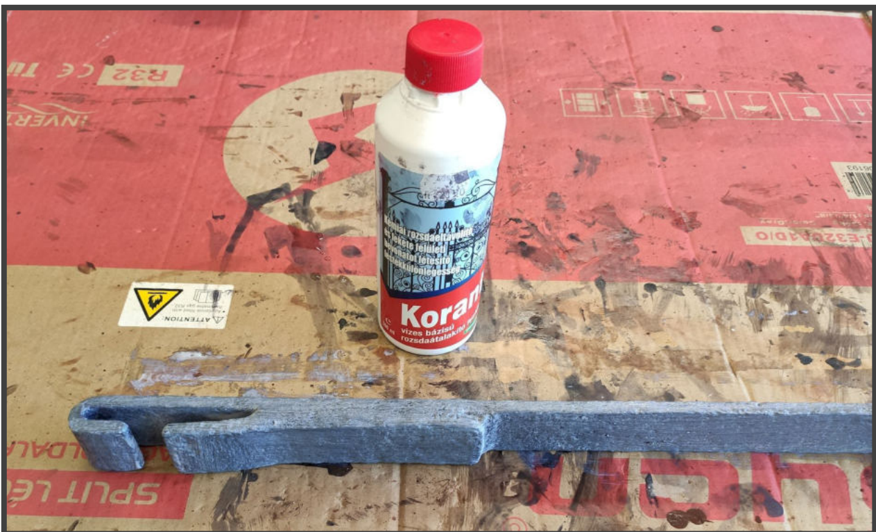
Rozsdaátalakítás után a felületek Korant-védőréteget kaptak (két ízben), hogy jobban ellenálljanak a környezet viszontagságainak.
