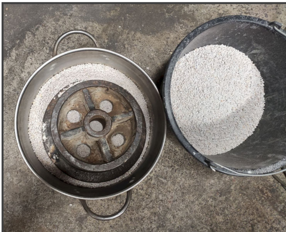
A kerék lassú hűtése duzzasztott perlitben (teljesen be lett fedve).
