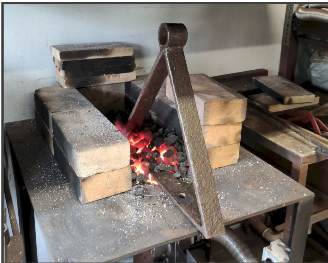
A keretek egyengetés előtti felmelegítése.
