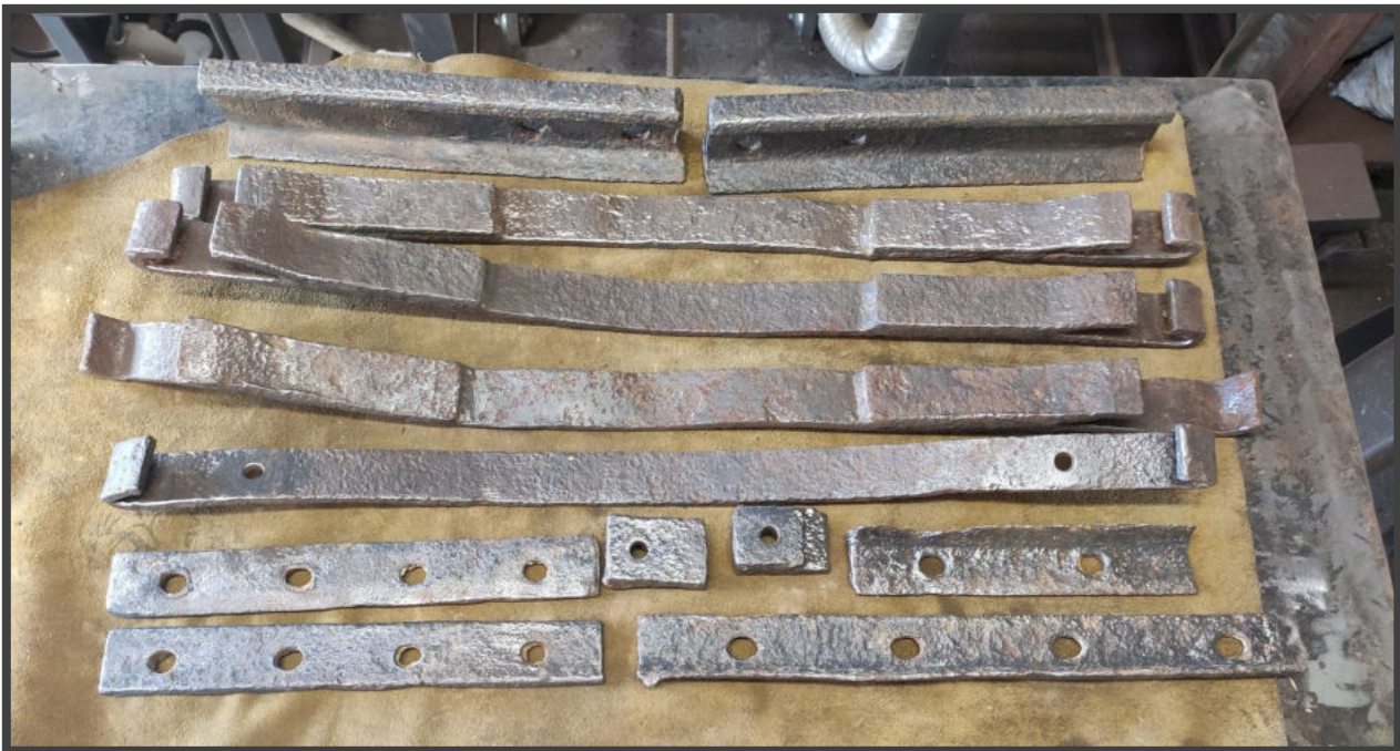
A megtisztított alkatrészek. Jól látható, hogy bár csak 1-2 napot heverték a műhelyben, a hajnali pára hatására a felületi rozsva ismét megjelent rajtuk. Ezért célszerű a letisztított, zsírtalanított alkatrészeket minél hamarabb passziválni, felületkezelni.
