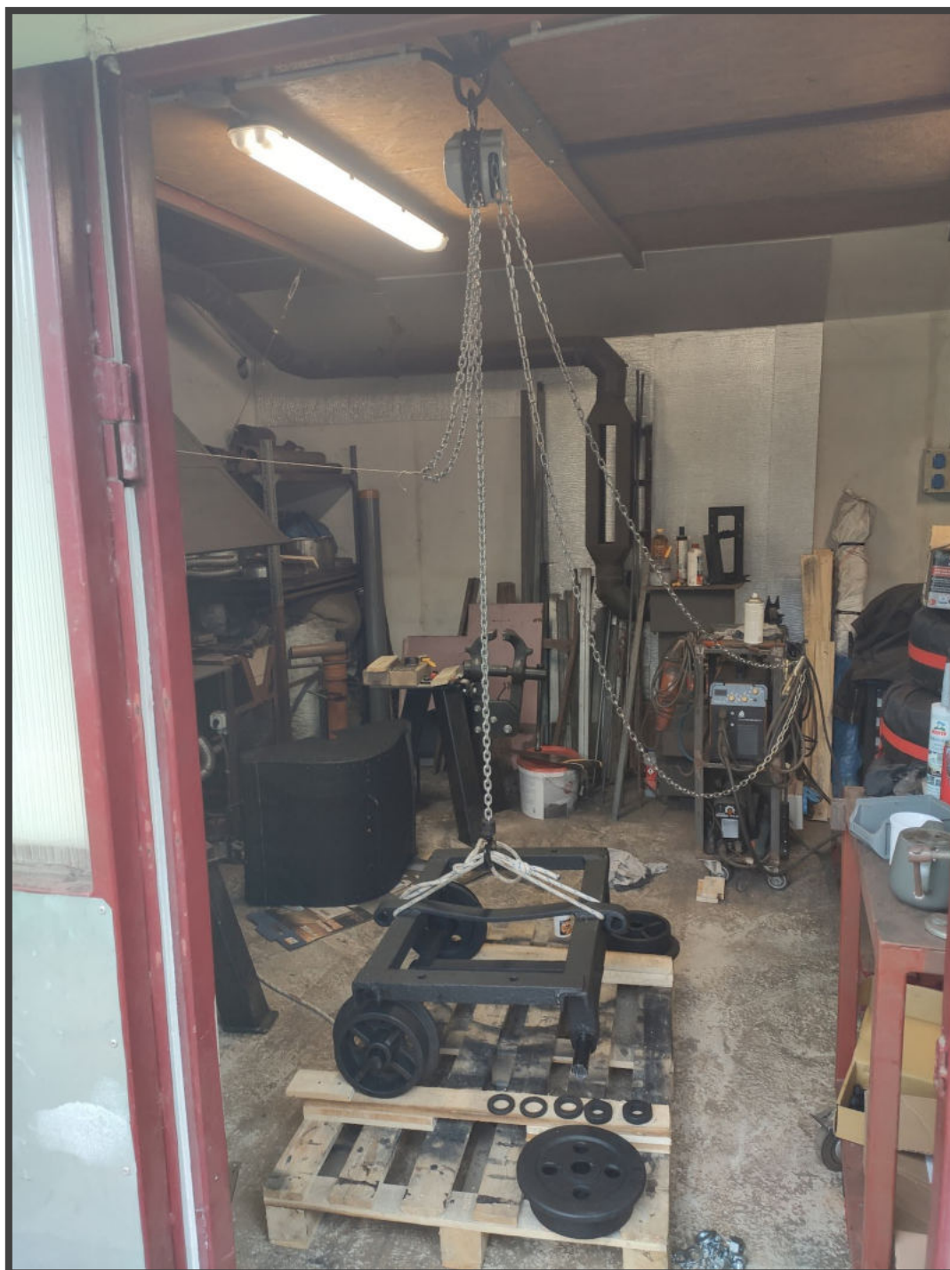
A csille összeszerelése könnyebb volt láncos emelő használatával.
