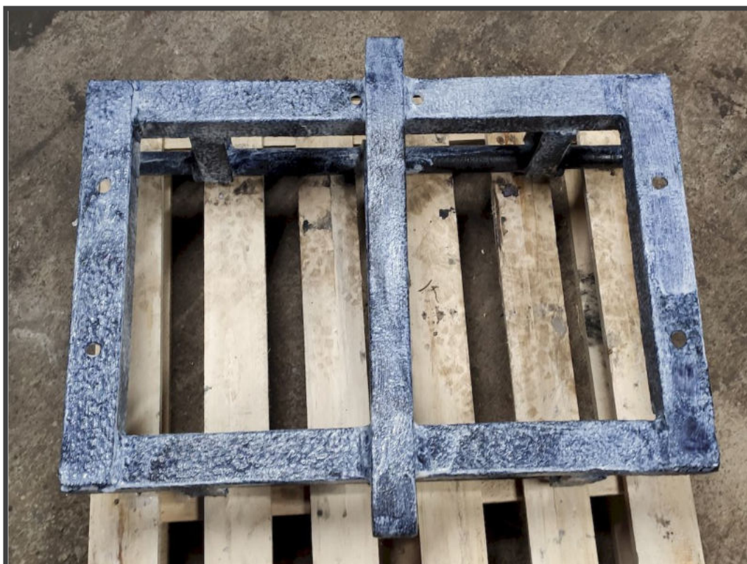
Az alváz Korant-os kezelése ecseteléssel.
