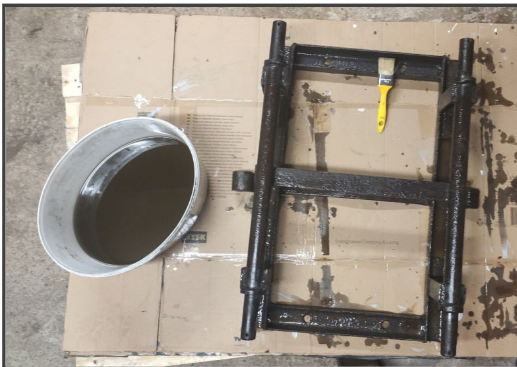
Az alváz RO55 oldattal való kezelése ecseteléssel.
