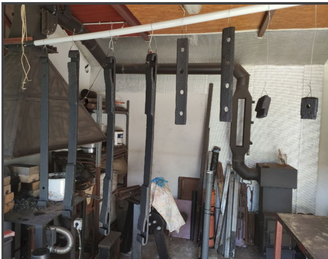
Az alkatrészek végül Trinát mattfekete akrilfestékből, kaptak két takaróréteget.
