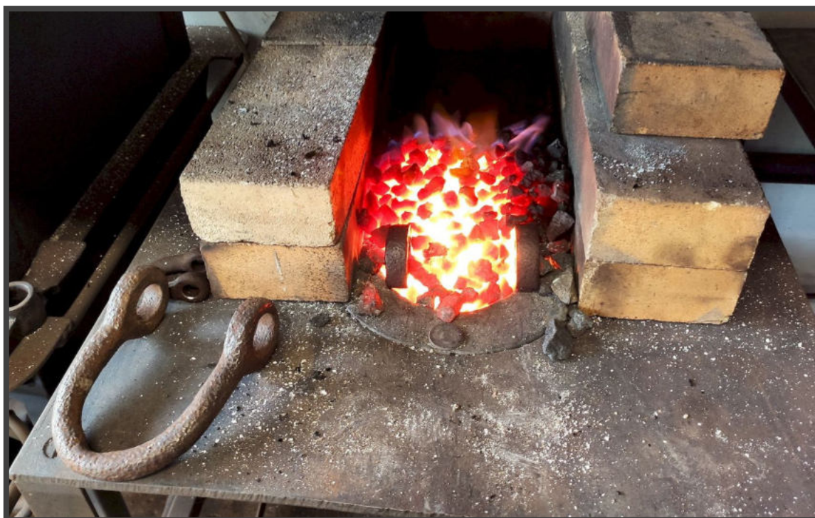
A vonószemek egyengetés előtti felmelegítése.
