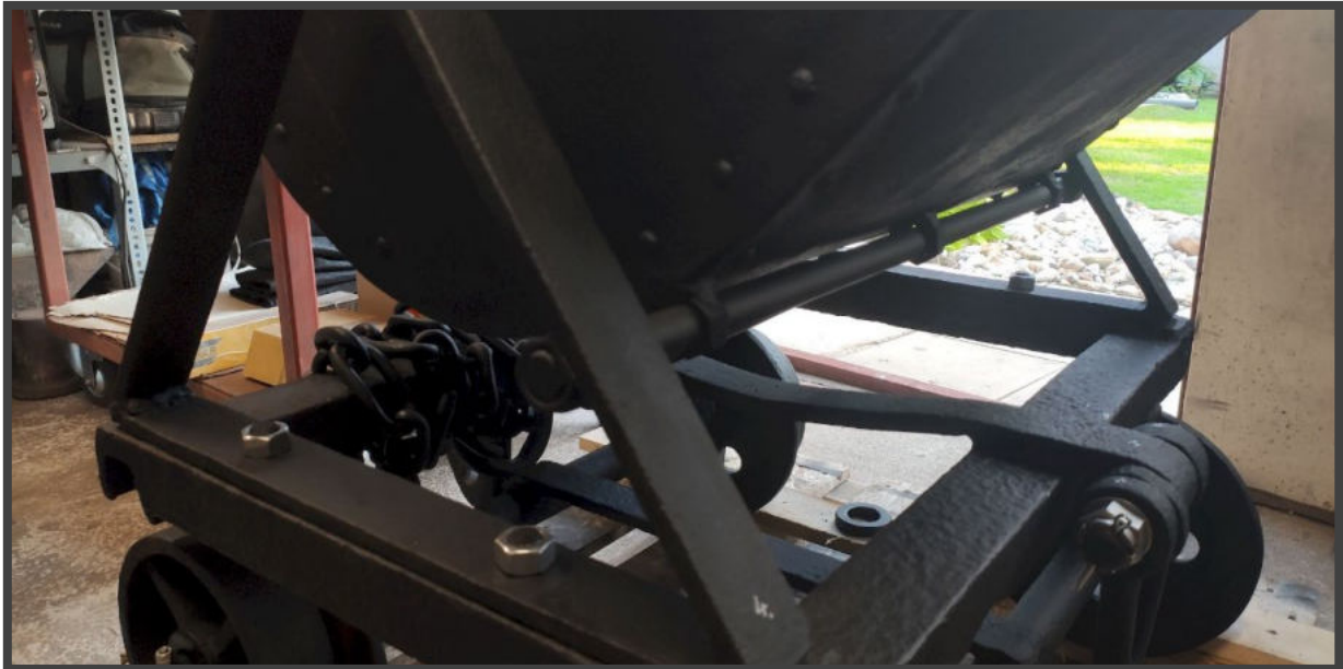
A bődön rögzítése. Később szükség esetén eltávolítható.
