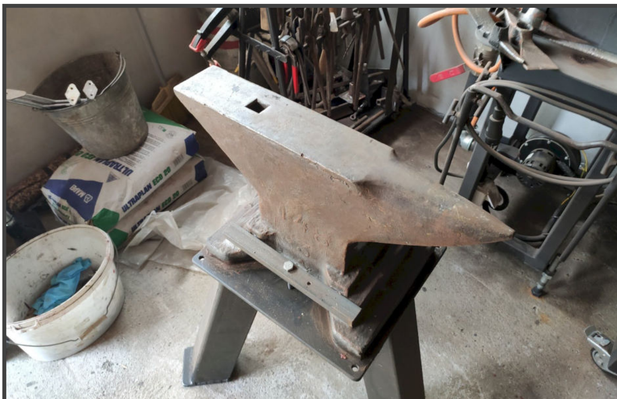
A középrész, és úgy általában a lapos egyenes részek egyengetés kovácsüllőn történt.
